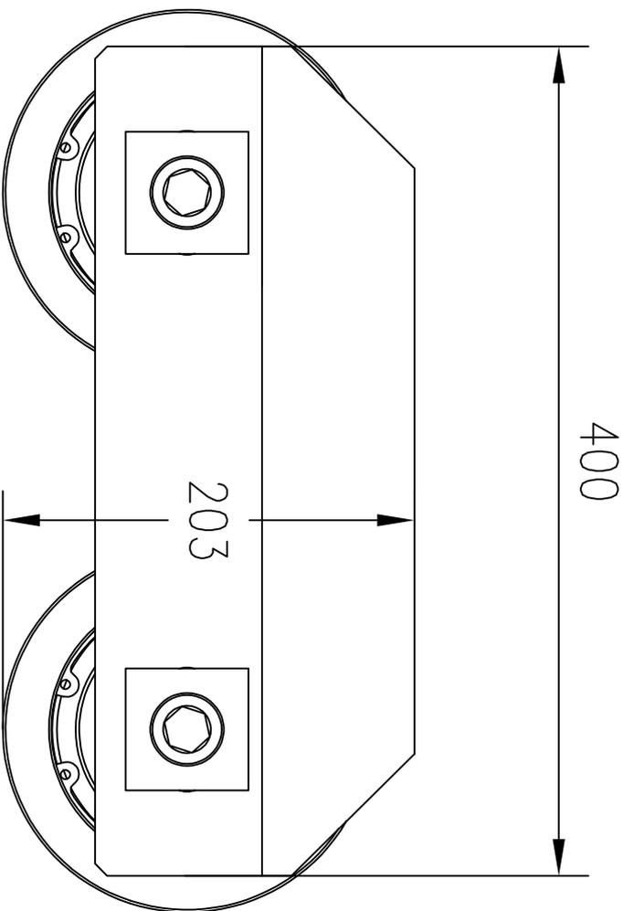
导向轮轮距可调节范围最小间距65.5mm最大间距113mm
