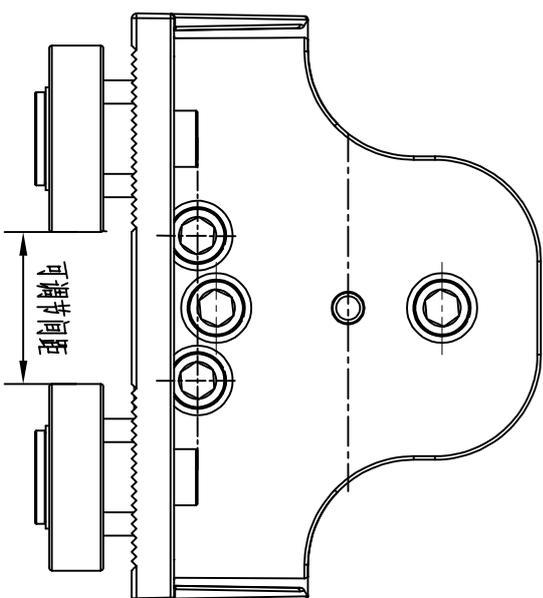
导向轮轮距可调节范围最小间距25mm最大间距80mm
